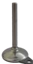
Part. R0747F - Pag. R43 Ø 80 • Acciaio inox • Sanificabile • Predisposto al fissaggio • Carico max. 25000 N.
